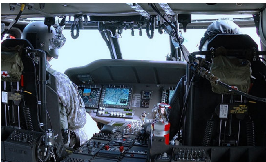
Widok na kabinę UH-60 M z przedziału transportowego, widoczne ekrany MFD, panele autopilota, oraz FMS
