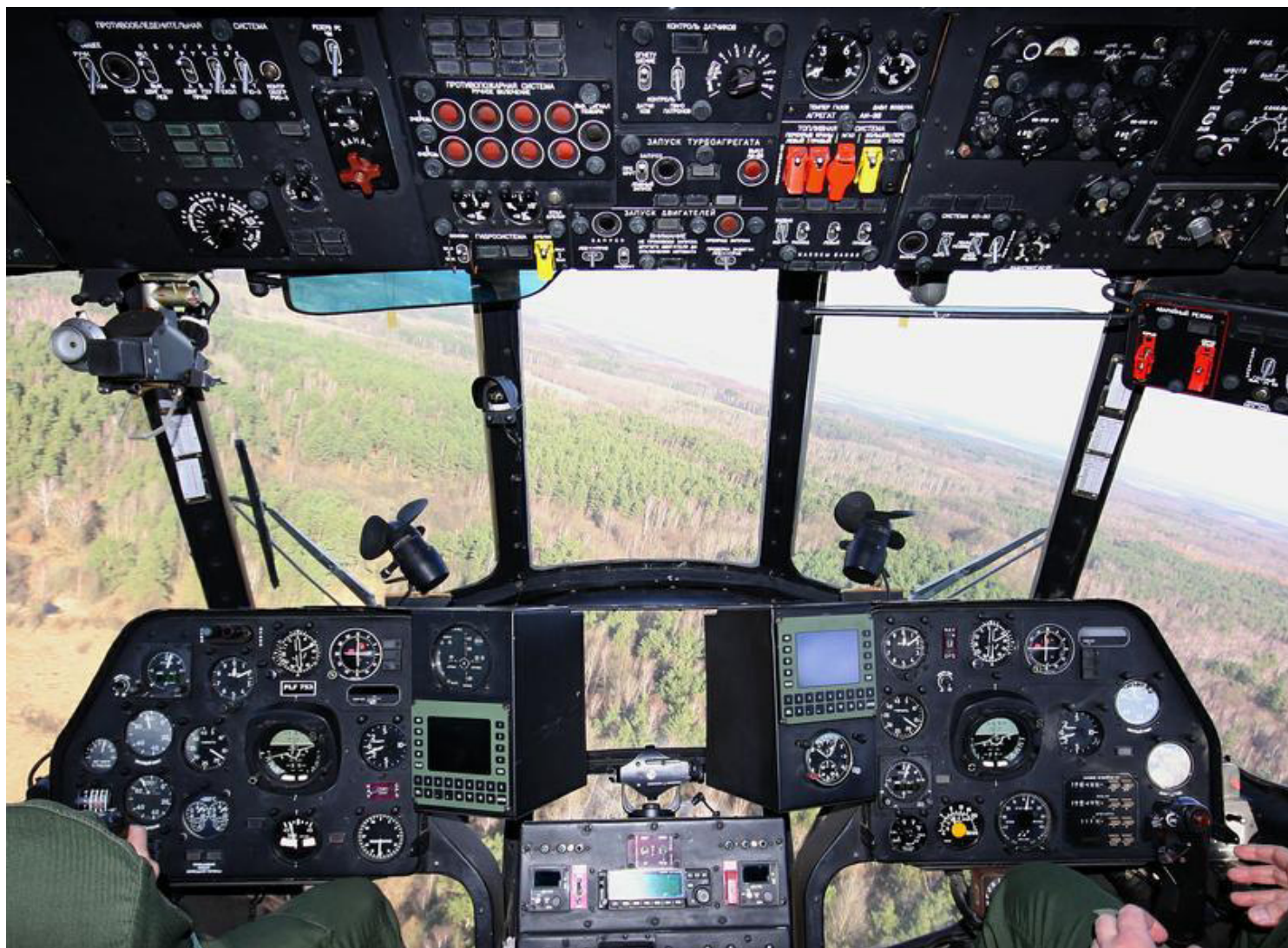
Powyższe zdjęcie pokazuje kokpit Mi-17 z dwoma panelami systemu łączności (monitory z kolorowym przyciskami). Na naszych Mi-17 zabudowanych jest pięć radiostacji.
