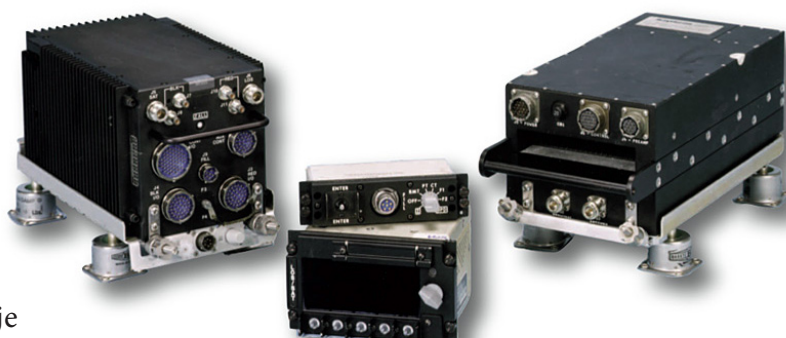
Radiostacje Raytheon AN/ARC-231 „Skyfire” zapewniające TRANSEC/COMSEC montowane m.in. na UH-60 L/M
